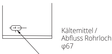
Position der Rohr-/Drahtöffnung auf der Rückseite
