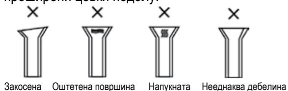
Закосена Оштетена површина Напукната Неоднаква дебелина
